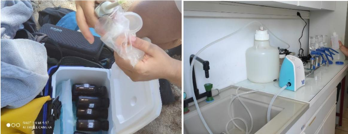
**Figure 21 : Préparation pour la réalisation des prélèvements et dispositif de filtration pour l'analyse de la chlorophylle, de la matière en suspension et du CDOM**
