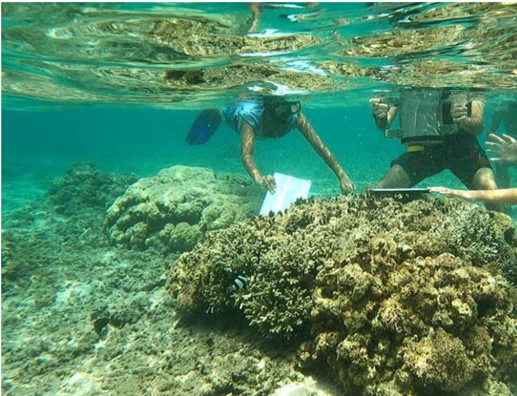
**Figure 23 : Acquisition de la réflectance du fond marin pour collecter les signatures spectrales des habitats benthiques par le spectromètre GER-1500**
